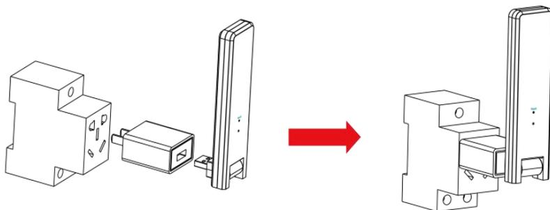
**Option 2: Schließen Sie die DTU an den Adapter an und stecken Sie diesen in die Stromleiste. Bitte stellen Sie sicher, dass sie mindesten 0,5 Meter über den Boden platziert ist, und versuchen Sie die DTU so gut wie möglich 90 Grad vertikal zum Boden zu installieren.**
