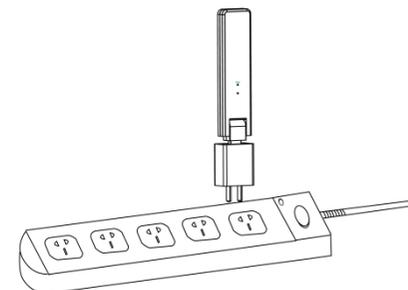
*Hinweis: Bitte installieren Sie die DTU nicht direkt über Metall oder Beton, um Signalschwächung zu vermeiden.*
