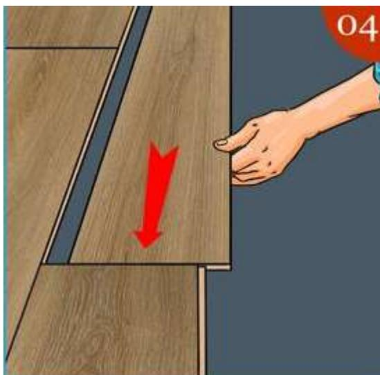
Die erste Diele sollte jedoch nicht kürzer als 30 cm sein. Der so entstandene Versatz (Verbund) stabilisiert die Fläche.
