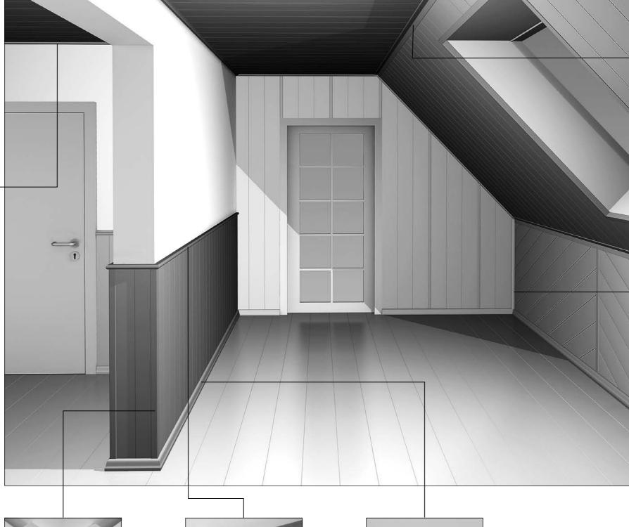
Die Faltleisten sind geeignet für alle Winkellösungen, zwischen 10° und 270°, z.B. Dachschrägen oder Innenecken.
