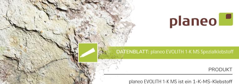
planeo EVOLITH 1-K MS ist ein 1-K-MS-Klebstoff speziell für die Verklebung von EVOLITH Slate&Stone teinfurnieren. Der Kleber ist für Innen und Außen geeignet sowie für die Anwendung im Nassbereich. (Nach den Kriterien der GEV eingestuft in die EMICODE-Klasse C1PLUS. Lizensierungs-Nummer: 13424, Franzözische VOC-Emissionsklasse A+)
