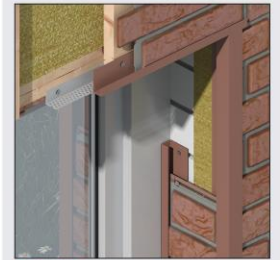
3 7 U-Profil und Eckprofil als Anschluss an einen Fensterrahmen und Fenstersturz
