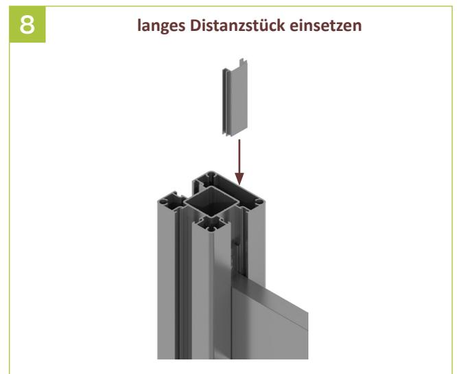
8 | Das lange Distanzstück in die Pfostennut von oben einschieben und ggf. kürzen.
