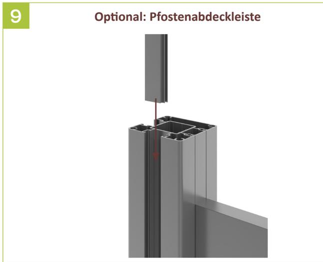
9 | Die Pfostenabdeckleisten von oben in die Pfostennut einschieben und mit der Unterkante des Pfostens bündig abschließen.
