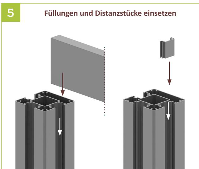
5 | Die Füllungsprofile und die kurzen Distanzstücke des New-Lumino Edge Elements nacheinander und im Wechsel von oben einschieben. Mit einem Füllungsprofil beginnen.
