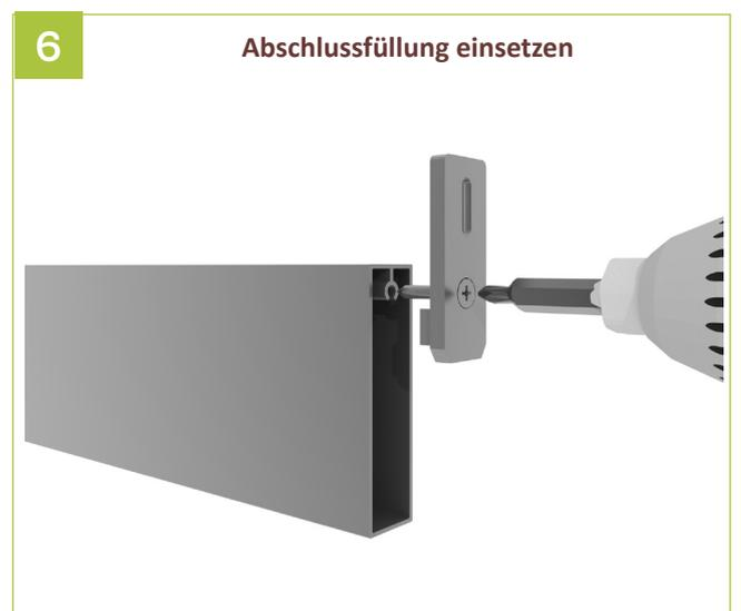
6 | Die Halterung für die Abschlussfüllung mit einer Schraube (im Lieferumfang enthalten) in das letzte Füllungsprofil verschrauben.
