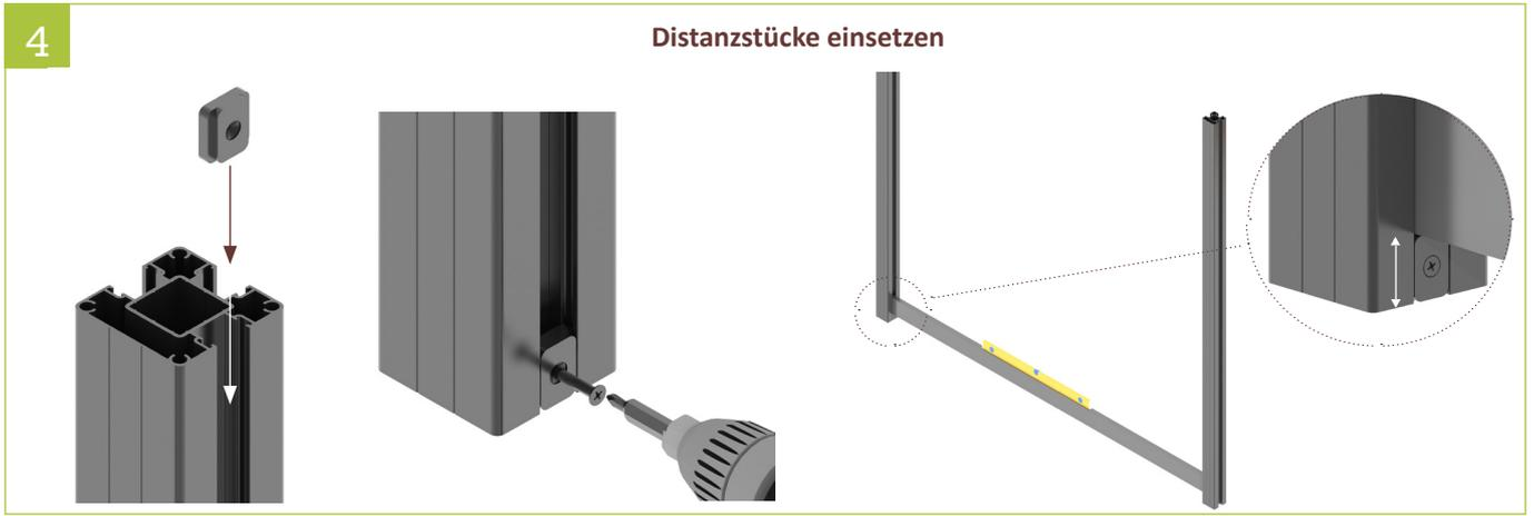
4 | Distanzstück hochkant in die Innenseite der Pfostennut einschieben, bündig mit der Unterkante des Pfostens abschließen, vorbohren und verschrauben. Zuerst auf einer Seite das Distanzstück befestigen. Das Distanzstück der gegenüberliegenden Seite mit Hilfe eines Füllungselementes und einer Wasserwaage ausrichten und befestigen
