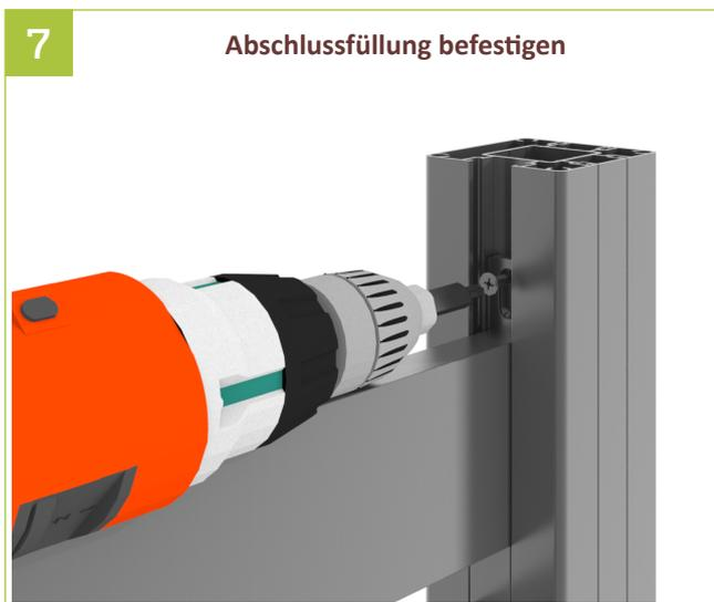
7 | Abschlussfüllung inkl. Halterung in die Pfostennut von oben einschieben und mit einer Schraube (im Lieferumfang enthalten) am Pfosten befestigen.
