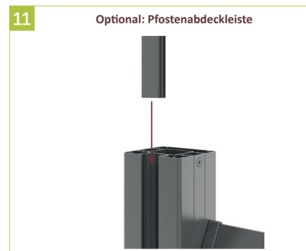
11 | Die Pfostenabdeckleisten von oben in die Pfostennut einschieben und mit der Unterkante des Pfostens abschließen.
