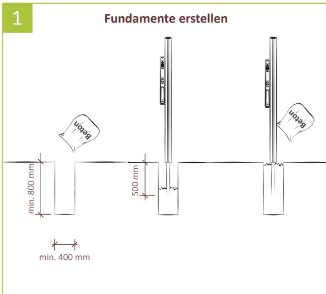
1 | Größe der Fundamente mindestens 400 x 400 x 800 mm sowie unter Berücksichtigung der Bodenbeschaffenheit.\* Ungefähr die Hälfte des Erdloches mit Beton füllen und verdichten. Anschließend die Pfosten setzen und ausrichten. Das Erdloch komplett mit Beton füllen und verdichten.
