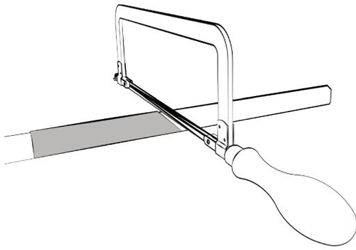
6b | Markieren Sie mit Hilfe der mitgelieferten Schablone den Gehrungsschnitt. Sägen Sie das Abschlussprofil mit einer Metallsäge passend zu und setzen Sie diese anschließend auf das Zaunelement. Optional kann das Abschlussprofil mit zwei Schrauben fixiert werden.
