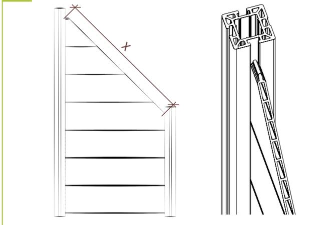
6a | Messen Sie die oben angegebene Länge. Bitte messen Sie immer von der Innenkante bis zur Innenkante des Pfostens!
