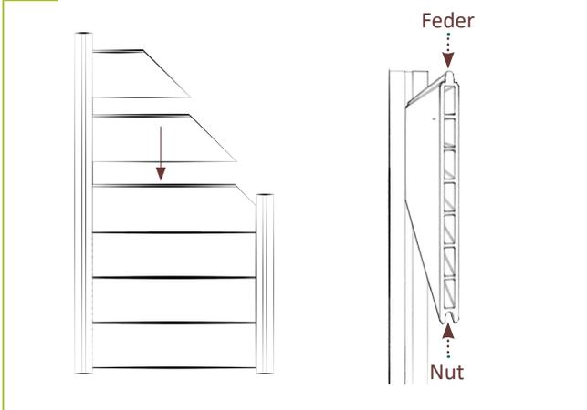
5 | Die Füllungelemente nacheinander von oben einschieben, dabei die Feder der Füllungelemente nach oben ausrichten.
