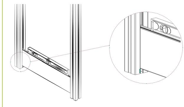
4 | Zuerst auf einer Seite das Distanzstück befestigen. Das Distanzstück der zweiten Seite mit Hilfe eines Füllungelementes und einer Wasserwaage ausrichten und befestigen.
