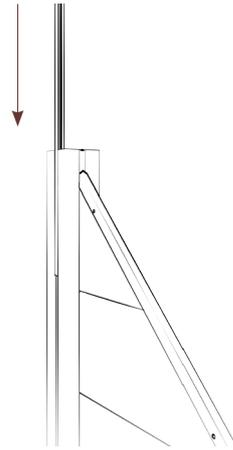
7 | Die Pfostenabdeckleisten von oben in die Pfostennut einschieben und mit der Unterkante des Pfostens bündig abschließen.
