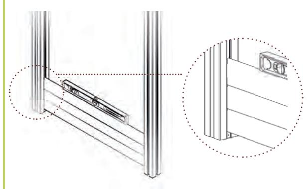
4 | Zuerst auf einer Seite das Distanzstück befestigen. Das Distanzstück der zweiten Seite mit Hilfe eines Füllungs-elementes und einer Wasserwaage ausrichten und befestigen.
