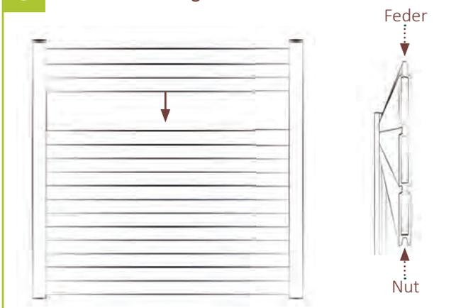
5 | Die Füllungselemente nacheinander von oben einschieben, dabei die Feder der Füllungselemente nach oben ausrichten.
