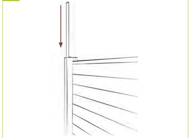
7 | Die Pfostenabdeckleisten von oben in die Pfostennut einschieben und mit der Unterkante des Pfostens bündig abschließen.
