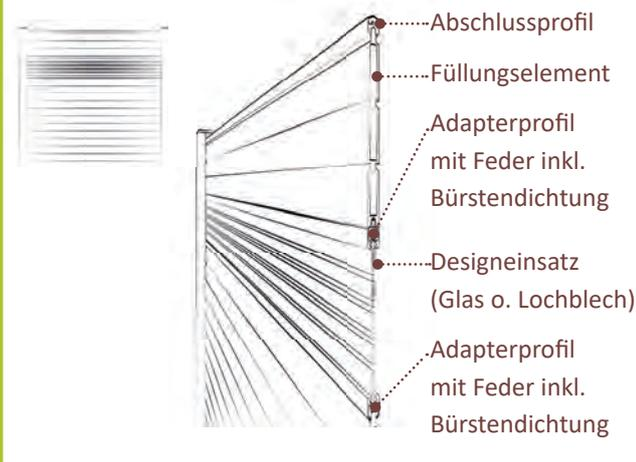
6a | Die Füllungselemente nacheinander von oben einschieben, dabei die Feder der Füllungselemente nach oben ausrichten. Bei der Montage des Designeinsatzes folgende Reihenfolge beachten: Adapterprofil mit Nut, Designelement, Adapterprofil mit Feder. Danach ein Füllungselement einschieben und das Abschlussprofil aufsetzen.
