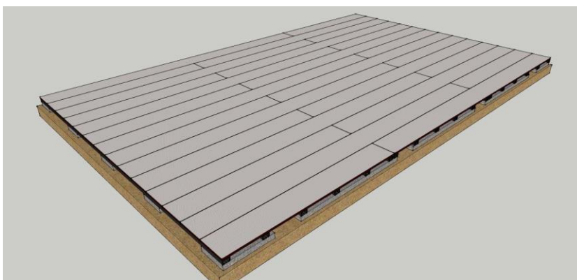
Abb. 3: Fertiges Deck mit versetztem Stoß
