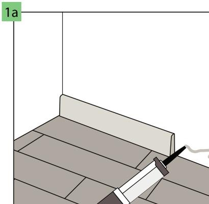
Dilatationen entlang den Wänden sollen mit passenden anhand von Klebstoff oder Klips montierten Sockelleisten zugedeckt werden. Wir empfehlen unsere Sockelleisten von planeo, die zu einzelnen Designbodendekoren passen und stoß- und kratzbeständig sind.
