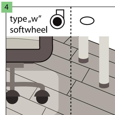
Es wird empfohlen Stühle mit Rollen vom Typ W zu nutzen und den Designboden zusätzlich mit einer Schutzmatte vor enormer Abnutzung zu sichern. Möbelbeine sollen mit Schutzuntersetzer (z.B. Filz-) versorgt werden.
