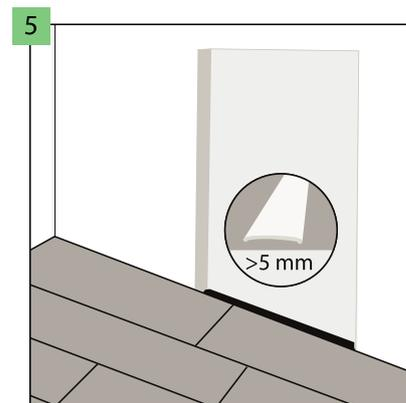
In folgenden Fällen ist in der Türöffnung zwischen den Räumen eine Dilatation von 5 mm zwecks Spannungsabbau anzuwenden: unregelmässige Form des Fußbodens in benachbarten Räumen, schwere Möbel in einem der Räume, aktivierte Bodenheizung nur in einem der Räume im Objekt. Bei einer Fläche von über 200 m<sup>2</sup> und/oder länger als 20 m<sup>2</sup> ist eine 10 mm Dilatation notwendig.
