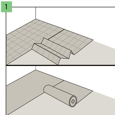
Verlegen Sie eine Trittschalldämmung quer zur Verlegerichtung der Paneele. Legen Sie die Nebenbahnen bündig aneinander an, lassen Sie sie überlappen oder verbinden Sie sie mit einem Klebeband. Vermeiden Sie Abstände.
