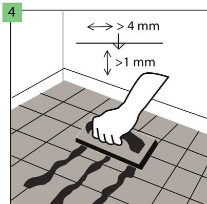
Bei der Verlegung auf keramischen Fliesen soll die Fugenbreite nicht mehr als 4 mm und die Tiefe nicht mehr als 1 mm betragen. Größere Abstände sind mit Harzmasse auszufüllen. Der Boden kann auf Fliesen mit Fugen mit einer Breite von bis zu 5 mm und einer Tiefe von 1 mm ohne deren Ausgleich verlegt werden, unter der Voraussetzung, dass die Unterlage Multiprotect Hardlay oder Vinclic Solid verwendet wird.
