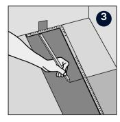
Legen Sie die letzte Diele mit der Unterseite nach oben, die Stirnseite ohne Verriegelungsleiste der Wand zugewandt. Der Abstand zur Wand soll ca. 10 mm betragen. Markieren Sie die Stelle, an der die Diele abgesägt werden soll.
