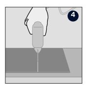
Sägen Sie die Länge zu, am besten mit Hilfe einer Stichsäge. Legen Sie die Diele mit der Dekorseite auf die Sägeunterlage. Als Alternative kann eine feingezahnte Handsäge benutzt werden, aber dann muss die Dekorseite nach oben zeigen.
