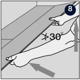
Heben Sie die Diele (zusammen mit der vorher gelegten Diele in der gleichen Reihe) etwa 30 mm an der Vorderkante an und drücken Sie diese in die Dielenreihe hinein. Wenn die Längskanten aufeinander stoßen, legen Sie die Dielen auf den Boden.
