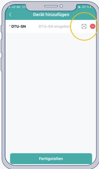
Beim Hinzufügen der Anlage kannst Du nacheinander mit der praktischen Scan Funktion den DTU WLite und den Mikro Wechselrichter hinzufügen. Scanne hierzu die Seriennummer am DTU und am Wechselrichter. Tippe nach dem Hinzufügen der Geräte auf "Fertigstellen" und folge den Schritten in der App um Deine Anlage hinzuzufügen.
