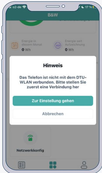
Um eine Verbindung mit dem DTU WLite herzustellen, musst Du diesen über WLAN zuerst mit Deinem mobil Telefon verbinden. Der DTU WLite wird Dir in Deinen WLAN Einstellungen als DTUL-XXXXXX angezeigt.
