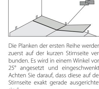
Die empfohlene Verlegerichtung ist längsseitig zur einfallenden Hauptlichtquelle. Als maximale zusammenhängende Verlegefläche empfehlen wir 10,00mtr. x 10,00mtr. Größere Flächen darüber hinaus bedürfen der Absprache und Freigabe durch die Anwendungstechnik. Zu allen aufstrebenden Bauteilen, wie Wände, Säulen oder Türdurchgängen sowie angrenzenden Flächen müssen entsprechende Dehnungsfugen fachgerecht eingebaut werden.
