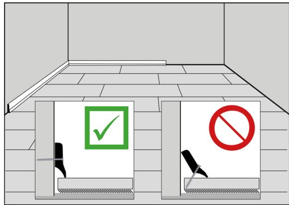
Verbleibende Fugen werden mit passenden Sockelleisten, Übergangsschienen oder Rohrrosetten abgedeckt.
