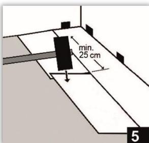
Die nächsten Dielen werden schräg in einem Winkel von ca. 20 Grad in der vorherigen Reihe längsseits eingeklickt. Das Kopfende wird durch leichtes Klopfen mit einem Gummihammer von oben nach unten verriegelt. Wiederholen Sie diesen Vorgang bis zum
