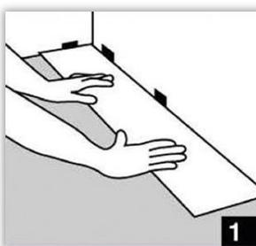
Legen Sie die erste Diele in die Ecke des Raumes, so dass die Nase der Klickverbindung zu Ihnen zeigt und die Rückseite der Diele zur Wand. Der Abstand von der Diele zur Wand soll 5-10 mm betragen und wird nach der Verlegung
