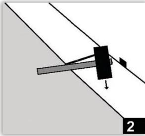
Danach klicken Sie die nächste Diele am Kopfende an, bis diese durch leichtes Klopfen mit einem Gummihammer in der Verbindung verriegelt und eben auf dem Boden aufliegt. Dies wiederholen Sie, bis Sie am Ende der ersten Reihe angekommen sind. Wichtig ist, dass
