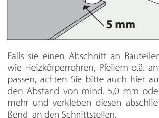
Falls sie einen Abschnitt an Bauteilen wie Heizkörperrohren, Pfeilern o.ä. anpassen, achten Sie bitte auch hier auf den Abstand von mind. 5,0 mm oder mehr und verkleben diesen abschließend an den Schnittstellen.
