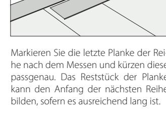
Markieren Sie die letzte Planke der Reihe nach dem Messen und kürzen diese passgenau. Das Reststück der Planke kann den Anfang der nächsten Reihe bilden, sofern es ausreichend lang ist.
