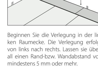
Beginnen Sie die Verlegung in der linken Raumecke. Die Verlegung erfolgt von links nach rechts. Lassen Sie überall einen Rand- bzw. Wandabstand von mindestens 5 mm oder mehr.
