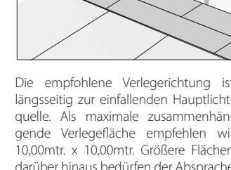
Die empfohlene Verlegerichtung ist längsseitig zur einfallenden Hauptlichtquelle. Als maximale zusammenhängende Verlegefläche empfehlen wir 10,00mtr. x 10,00mtr. Größere Flächen darüber hinaus bedürfen der Absprache und Freigabe durch unsere Anwendungstechnik. Zu allen aufstrebenden Bauteilen, wie Wände, Säulen oder Türdurchgängen sowie angrenzenden Flächen müssen entsprechende Dehnungsfugen fachgerecht eingebaut werden.
