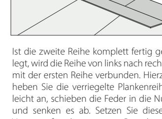
Ist die zweite Reihe komplett fertig gelegt, wird die Reihe von links nach rechts mit der ersten Reihe verbunden. Hierzu heben Sie die verriegelte Plankenreihe leicht an, schieben die Feder in die Nut und senken es ab. Setzen Sie diesen Vorgang für die gesamte Raumlänge fort und entfernen zum Schluss die Abstandskeile.
