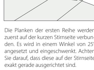
Die Planken der ersten Reihe werden zuerst auf der kurzen Stirnseite verbunden. Es wird in einem Winkel von 25° angesetzt und eingeschwenkt. Achten Sie darauf, dass diese auf der Stirnseite exakt gerade ausgerichtet sind.
