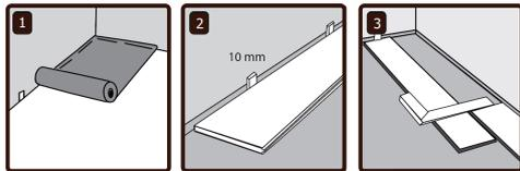
**3** Die letzte Dielen der Reihe ist so umzukehren, dass das Stück, welches noch in diese Reihe passt, mit der Kopffeder zur Wand zeigt. Die hierdurch festgestellte Abkürzungsstelle ist mit einem Winkel quer über die Dielen festzuhalten und abzugsägen, und danach ist die Dielen mit der Schnittstelle zur Wand zu verlegen. Vergessen Sie nicht, die Dielen mit einem Abstandskeile zur Stirnwand festzuhalten.
