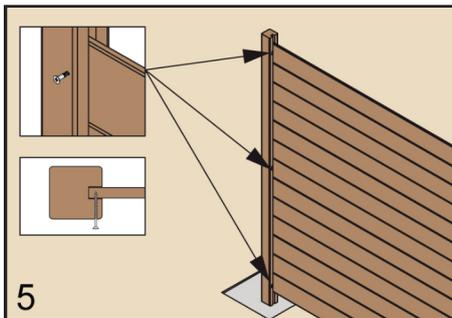
5 Drei Verschraubungen durch den Pfosten in die Planke, sorgen für ausreichend Halt und Stabilität.
