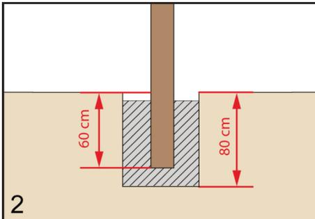
2 Füllen Sie die Löcher mit Beton auf. Achten Sie auf die entsprechenden Aushärtungszeiten des Betonherstellers.
