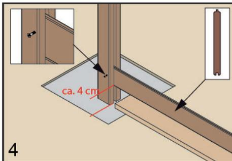
4 Als konstruktiven Holzschutz empfehlen wir einen Abstand von ca. 4 cm zum Untergrund, um das Material vor möglichen Witterungsschäden zu schützen.
