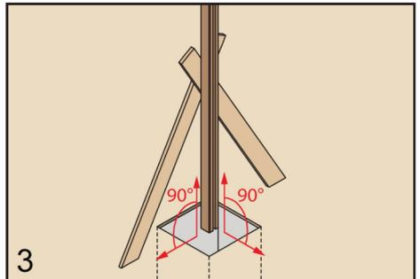
3 Der Pfosten muss von allen Seiten im rechten Winkel ausgerichtet werden. Fixieren Sie ihn mit einer Hilfskonstruktion.
