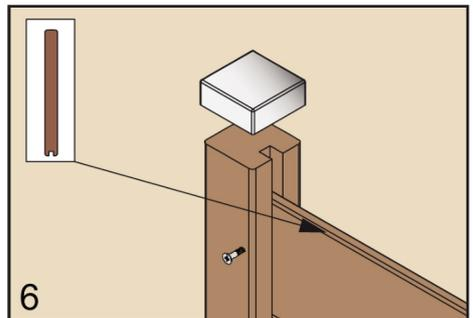
6 Als oberste Planke können Sie das Abschlussbrett ohne obere Feder einsetzen. Nach Aufsetzen der beiliegenden Abdeckkappe, haben Sie den Bau beendet.
