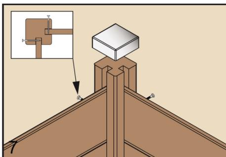
Beim Verschrauben der Eckpfosten ist zu beachten, dass die Schrauben von außen gesetzt werden sollten.
