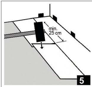
Die nächsten Dielen werden schräg in einem Winkel von ca. 20 Grad in der vorherigen Reihe längsseits eingeklickt. Das Kopfende wird durch leichtes Klopfen mit einem Gummihammer von oben verriegelt.
