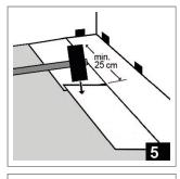
Die nächsten Dielen werden schräg in einem Winkel von ca. 20 Grad in der vorherigen Reihe längsseits eingeklickt. Das Kopfende wird durch leichtes Klopfen mit einem Gummihammer von oben verriegelt. Wiederholen Sie diesen Vorgang bis zum Ende des Raumes.
