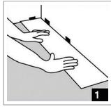
Legen Sie die erste Diele in die Ecke des Raumes, so dass die Nase der Klickverbindung zu Ihnen zeigt und die Rückseite der Diele zur Wand. Der Abstand von der Diele zur Wand soll 5 mm betragen und wird nach der Verlegung mit einer Sockelleiste überdeckt.
