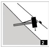
Danach klicken Sie die nächste Diele am Kopfende an, bis diese durch leichtes Klopfen mit einem Gummihammer in der Verbindung verriegelt und eben auf dem Boden aufliegt. Dies wiederholen Sie, bis Sie am Ende der ersten Reihe angelangt sind. Wichtig ist, dass die erste Reihe plan liegt.
