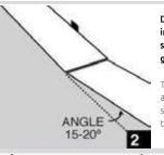
Daraufhin wird die nächste Diele kopfseitig in einem Winkel von ca. 15-20 Grad eingesetzt und nach unten gedrückt bis diese eingeklickt ist und auf dem Untergrund aufliegt.
