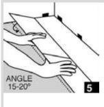
Die zweite Diele in der zweiten Reihe wird wieder mit einem Winkel von ca. 15-20 Grad kopfseitig in die Diele zuvor eingeklickt. Hier heben Sie die erste Diele leicht an, so dass die Diele in der Nut der ersten eingeschoben werden kann. Danach drücken Sie das Ganze mit leichtem Druck nach unten.
