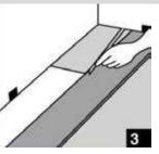
Verlegen Sie diese Reihe exakt so weiter, bis das Ende der Reihe erreicht wird. Nehmen Sie für das letzte Stück eine ganze Diele, drehen Sie diese herum und schneiden Sie diese der Reihe passend auf die benötigte Länge zu. Danach drehen Sie den Abschnitt der Diele wieder herum und fügen Sie diesen als Endstück in der Reihe ein.
