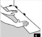
Beginnen Sie mit der Verlegung in der linken Ecke des Raumes. Nehmen Sie die erste Diele so, dass die Federseite links zur Wand zeigt. Der Wandabstand muss 5 mm betragen. Diesen können Sie mittels Keilen herstellen.
